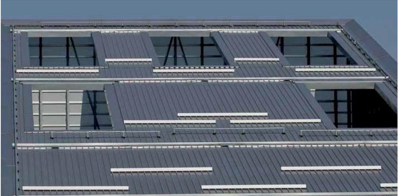
Isofire Roof es un panel autoportante de doble piel, aislado con fibra de lana mineral elaborado con una exclusiva capa aislante compuesta por tiras de lana mineral. El sistema de fijación es de tipo penetrante con posibilidad de utilizar tapones expuestos.
